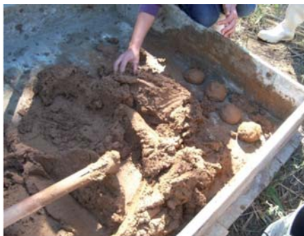
Figura 10 - Massa após a adição de água
